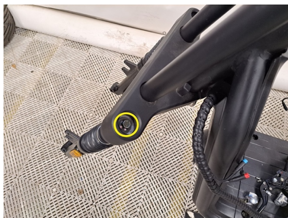
Irrota vasemman etujousen kiinnityspultti. (hylsy 12 mm).
